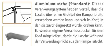
**Aluminiumlasche (Standard):** Dieses Verankerungssystem hat den Vorteil, dass die Lasche über einen Großteil der Rampenbreite verschoben werden kann und sich im Kopf, in den sie zuvor eingesetzt wurde, drehen kann. Es werden eigene Verschlussdeckel für den Kopf mitgeliefert, damit die Lasche während der Verwendung nicht aus der Rampe rutscht.
