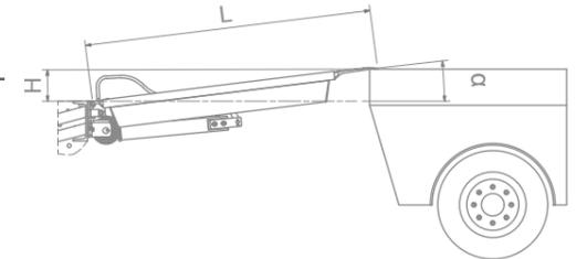
Unter Höhenunterschied (H) versteht man die Höhe der Lade- fläche vom Schwerpunkt der Brücke oder Bordwand.
