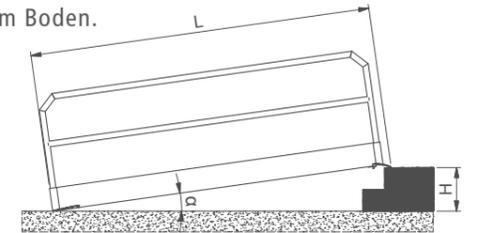
Die oben genannte italienische Rechtsvorschrift gestattet höhere Gefälle in den Fällen, wenn diese im Verhältnis zur effektiven linearen Abwicklung der Rampe angepasst werden. In diesem Fall muss das Verhältnis zwischen Gefälle und Länge in jedem Fall einen niedrigeren Wert aufweisen, als jener, der aus der Interpolationslinie der nachstehenden Grafik hervorgeht (Beispiel: bei Anpassung ist ein maximales Gefälle von 12% für Längen kleiner oder gleich 3.000 mm zulässig).
