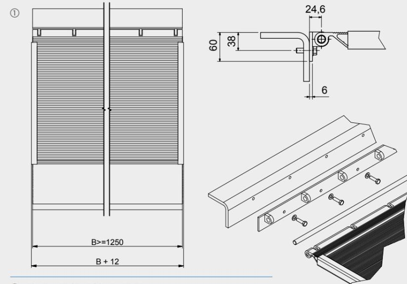
① MODELL MIT STAHLSCHARNIEREN
