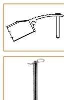
**Axe en acier (sur demande) :** Un axe en acier zingué de 14 mm de diamètre avec une tête 24 mm diamètre peut être introduit à travers les trous de la tête standard de la rampe et du plan de chargement.
