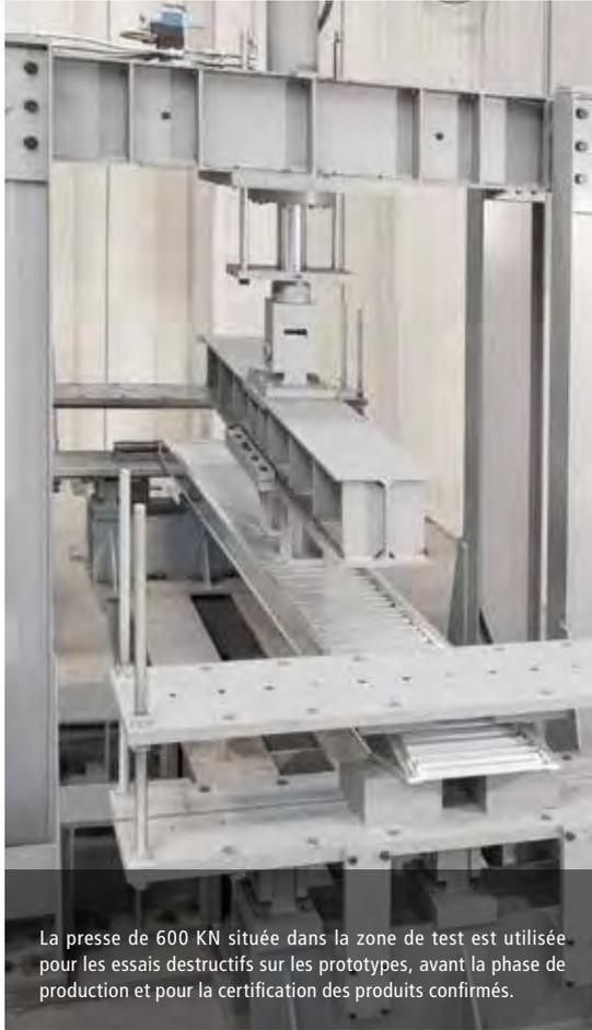
La presse de 600 KN située dans la zone de test est utilisée pour les essais destructifs sur les prototypes, avant la phase de production et pour la certification des produits confirmés.
